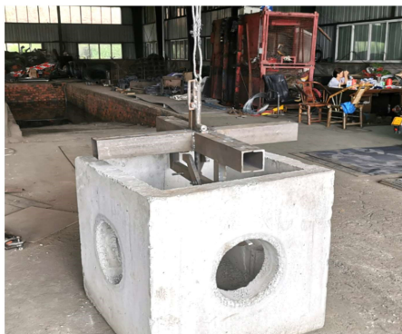
图2 吊具提升构件示意图
