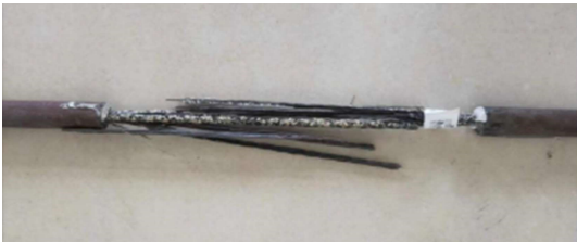
图 1 试样断裂后状态图
