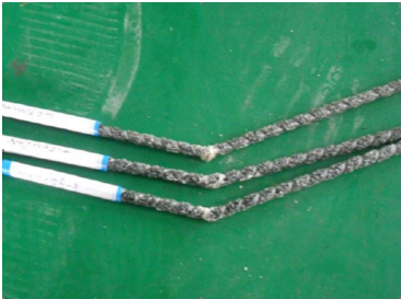
图 2 弯曲试验后样品状态图
