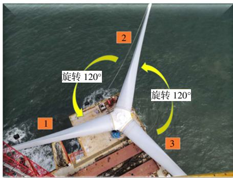
图 1 轮毂旋转工装应用
