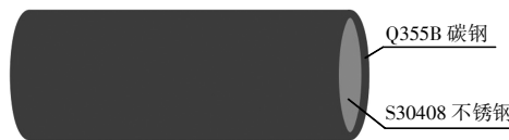
图 1 内衬不锈钢复合管示意图
