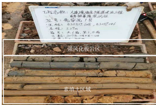
图 1 现场钻孔地质情况
