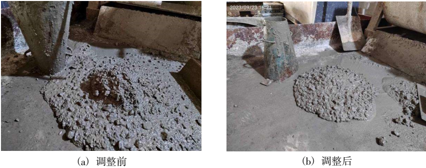
图 3 骨料调整前后 C30 混凝土状态对比
