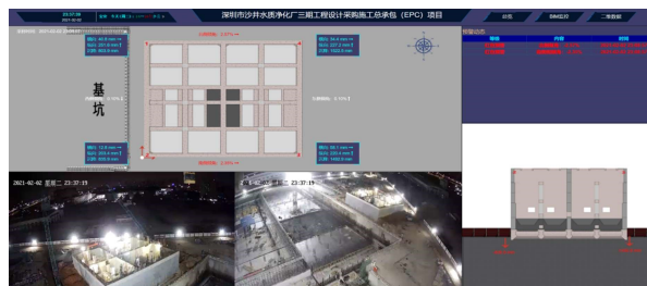
图 2 沉井下沉自动监测系统
